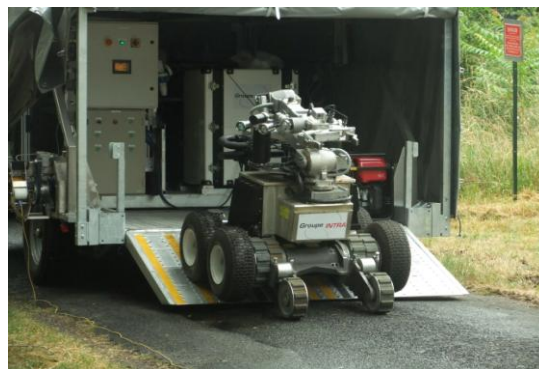
Démonstration d'un transport et d'un déchargement télécommandés d'un engin d'intérieur
