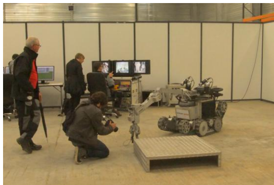
Démonstration d'un engin d'intérieur récupérant un objet Au fond, le poste de pilotage, (en principe positionné à quelques centaines de mètres).
